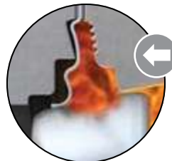
Presión de línea aplicada desde la dirección del flujo no preferida . (Durante o después de un evento de incendio .)
