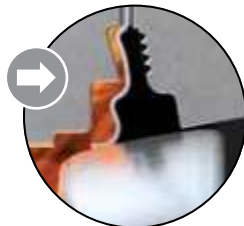
Presión de línea aplicada desde la dirección del flujo preferida . (Durante o después de un evento de incendio .)
